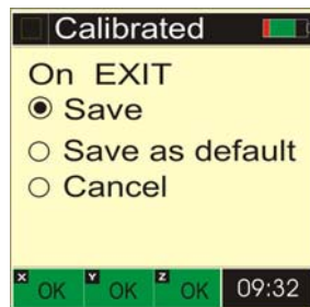
Фигура 3-10 При EXIT (ИЗЛИЗАНЕ ОТ МЕНЮТО), калибрираният предавател може да се предлага по подразбиране
