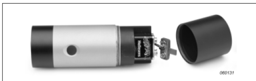
Фиг.2.1 9V –ова батерия, поставена в калибратора
