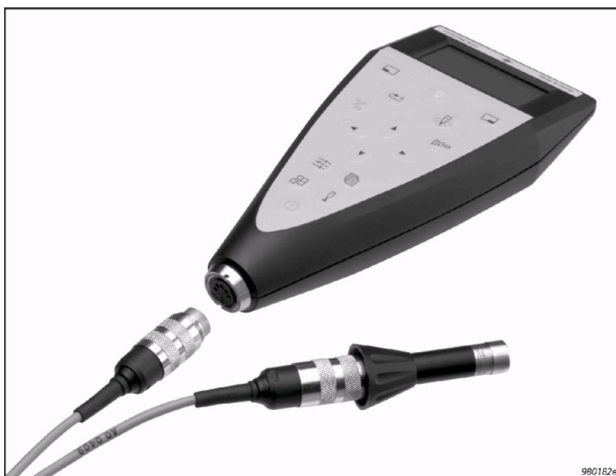
Фиг. 2.3 Свързване на микрофонен удължителен кабел към шумомера
